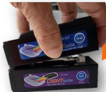
Verbindung zu Stromversorgung & Steuerbus
